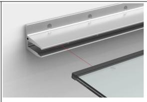
Kantenschutzprofil auf das Glas stecken (Richtung beachten) und anschließend die Scheibe mit den Bohrlöchern nach unten in das Vordachprofil einführen.
